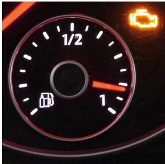
Abb. 11 und Abb. 12 Erdgasfüllstand- anzeige und Tankstutzen eines Erdgasfahrzeuges
